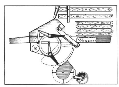
Funktion der Doppelschwinge am Ladewagen HAGEDORN Typ LD mit Schneidwerk (Scherenschnitt)
