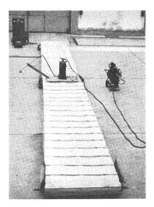
Abb. 6: Einrichtung zur Herstellung von Spritzbildern
