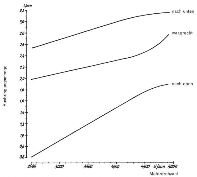
Abb. 10: Messung bei einem rückentragbaren Sprühgerät
