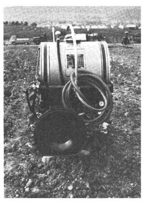
Abb. 7: Eine Aufsattelspritze mit Zusatzausrüstung für Weinbauspritzung
