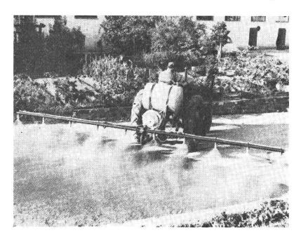
Abb. 8: Ein Sprühgerät mit Feldsprühbalken
