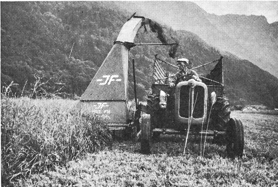
Der JF-MÄHFELDHÄCKSLER beim Mähen und Aufladen von Gras. Er ist leicht in der Bedienung und vielseitig in der Verwendbarkeit.
