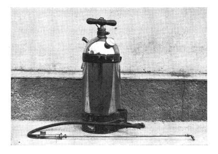
Abb. 1: Pressluftspritze
