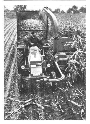
TRACTO-CONTROL ist die Bezeichnung für ein neues Krafthebersystem, das nach Widerstand, Lage und Mischfunktion regelt. Die Regelung erfolgt über die Unterlenker des Dreipunktgestänges und ist in besonderem Masse exakt. Sämtliche zur Auslieferung kommenden Traktoren vom Typ «Super 6» sind serienmässig mit diesem neuen Kraftheber ausgerüstet. Die übrigen «Super»-Typen können wahlweise mit der bisherigen oder aber der neuen Kraftheber-Anlage geliefert werden.
