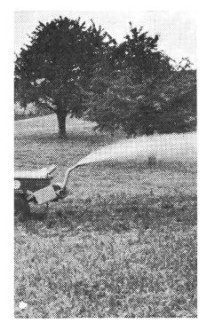
uckfaß beim Güllen (12 m Streubreite). umpe erfolgt über die Zapfwelle.
