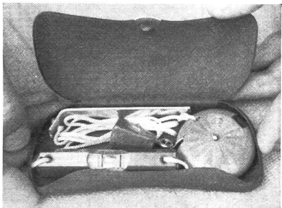
Abb. 2: Zusammengeklappt nimmt der neue Steigungsmesser nur wenig Platz ein; bequem lässt er sich in der Westentasche mitnehmen.
