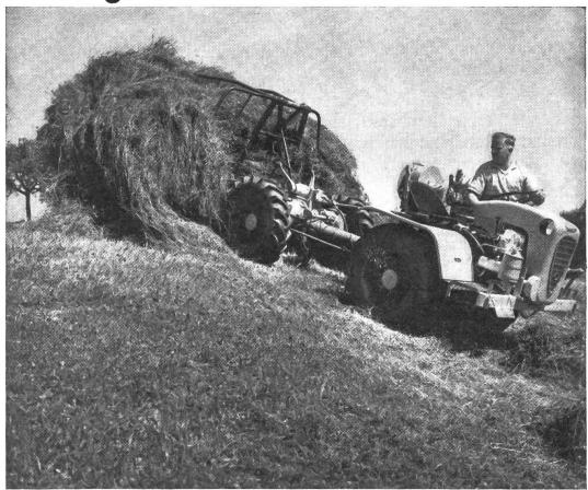
**Der Heuschwanz,** am Pullax angebaut, ist die ideale Lösung dank der grossen Vorderachs-Belastung. Alle Geräte, die für eine Traktor-Normhydraulik gebaut sind, können am Pullax verwendet werden, wie Pflüge, Schnellheuer etc...
