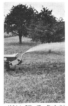
ruckfaß beim Güllen (12 m Streubreite). jumpe erfolgt über die Zapfwelle.
