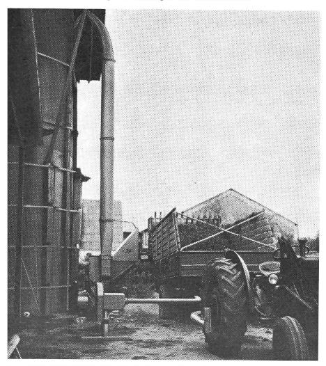
Das JF-SILOWURFGEBLÄSE (Zapfwellenantrieb) und der JF-Allzweckwagen (als Häckselwagen) mit dem Kombi- und Seitenablader beim Füllen des Silo.
