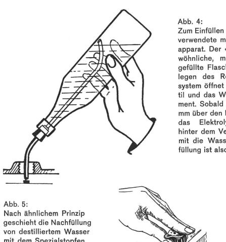
Zum Einfüllen von destilliertem Wasser verwendete man den «VITO» - Einfüllapparat. Der «VITO» wird in eine gewöhnliche, mit destilliertem Wasser gefüllte Flasche montiert. Durch Auflegen des Rohres auf das Plattensystem öffnet sich das Verschlussventil und das Wasser fliesst in das Element. Sobald das Niveau ungefähr 10 mm über den Platten liegt, verschliesst das Elektrolytniveau das Luftloch hinter dem Ventil und unterbindet damit die Wasserzufuhr. - Eine Ueberfüllung ist also ausgeschlossen.
