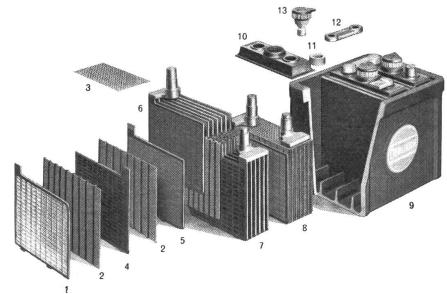
Abb. 1: Die Bestandteile einer Batterie:
