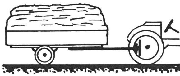
Anhänger mit gradem Grendel ist richtig angehängt. Traktor kann die gleiche Motorkraft wie ohne Anhänger auf den Boden bringen.
