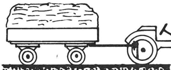
Richtige Anhängung von Drehschemelwagen. Auch hier werden alle Räder gut belastet.
