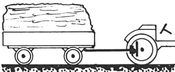
Richtige Anhängung. Die volle Motorkraft des Traktors wird auf alle Räder übertragen.
