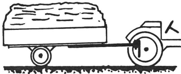
Anhänger ist hier zu hoch angehängt. Da Vorderachse entlastet wird, ist der Traktor in seiner Lenkfähigkeit beeinträchtigt.
