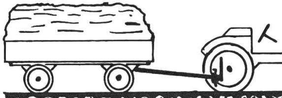
Anhängung zu tief gewählt. Die Triebräder des Traktors rutschen durch, weil sie beim Anziehen zu stark entlastet werden.
