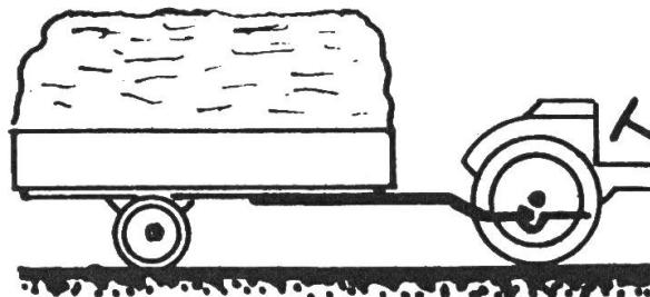
Anhängung bestmöglich gewählt (Hitch-Kupplung). Alle Räder werden gut belastet und die volle Motorkraft wird ausgenutzt.
