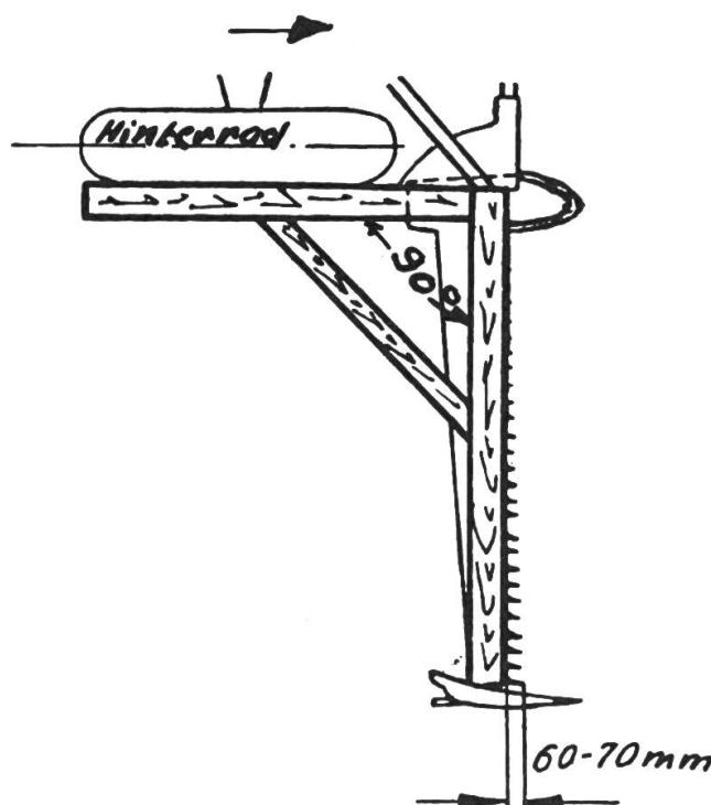
Messung der Voreilung des Mähbalkens am Traktor-Zwischenachs-Anbaumähwerk mittels Holzwinkel von 90°.
