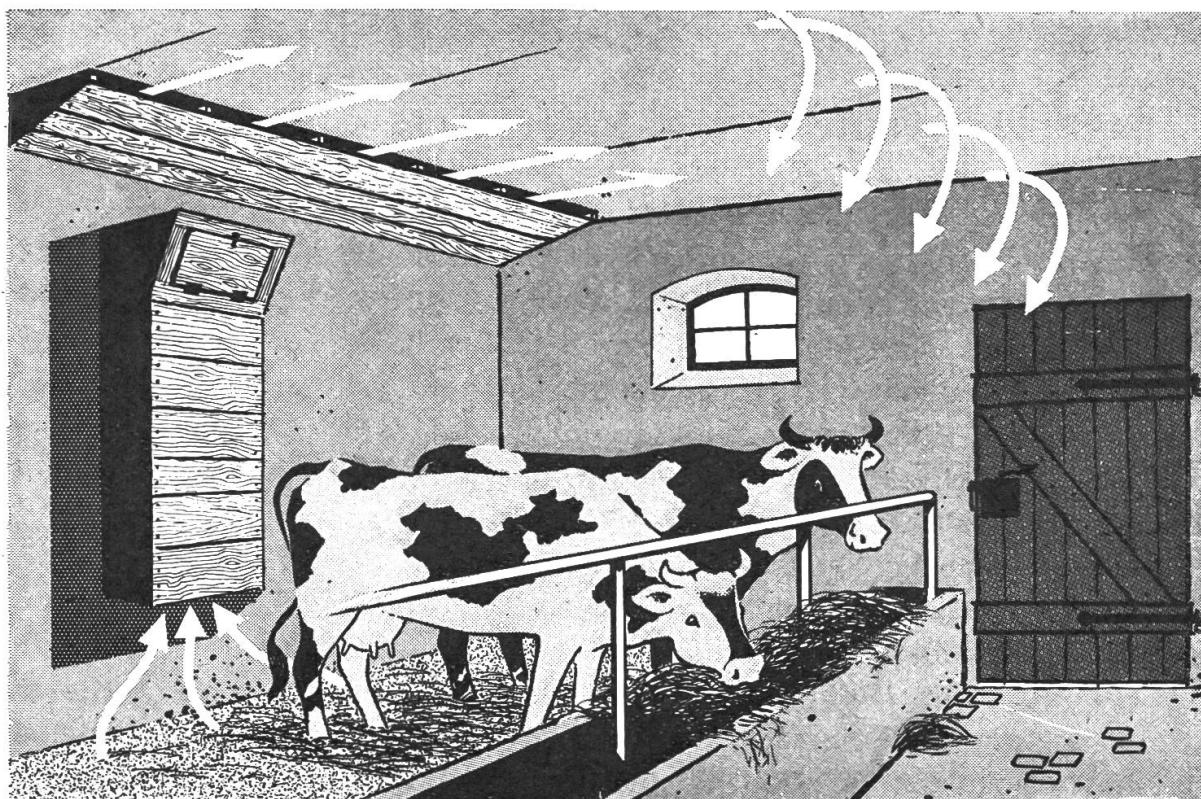
Darstellung des richtigen Luftwechsels und des zweckmässigen Einbaues von Stall-Lüftern, Abluftkästen und Lufteintrittsschlitzten. Die Frischluft strömt durch Schlitze ein, verteilt sich unter der Decke und sinkt dann allmählich in den Aufenthaltsbereich der Tiere. Die verbrauchte Luft wird unten, wo sie sich ansammelt, abgesaugt. So entsteht ein dauernder, gleichmässiger und zugfreier Luftwechsel.
