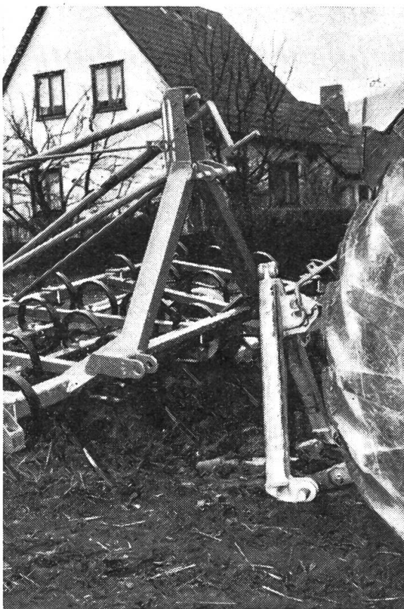
Bild 1: Das Geheimnis der neuen Schnellkupplung sind zwei Dreiecke aus U-Eisen. Das Dreieck am Traktor ist kleiner und passt genau in das Dreieck am Gerät.
