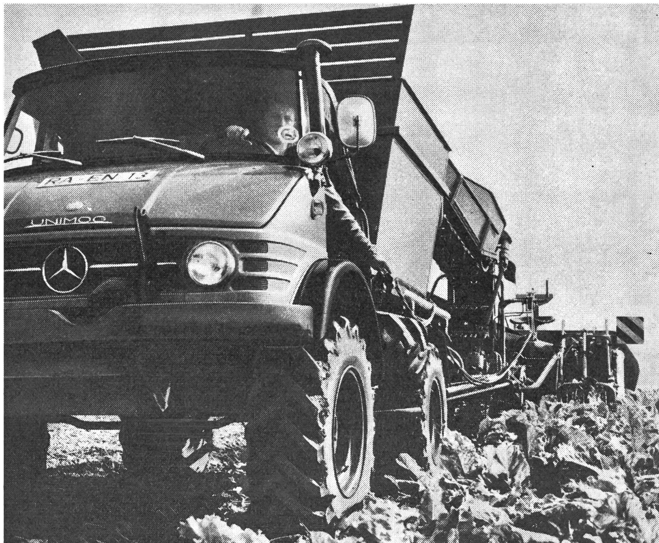
Linke Hand an linkem Griff. 1-Mann-Bedienung vom Fahrersitz aus.
