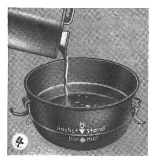
4 Motoröl nur bis zur unteren Normal-Oelstandmarke einfüllen
