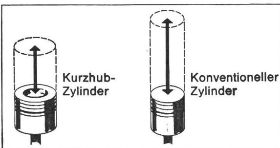
Dank dem quadratischen Bohrungs- und Hubverhältnis minimalste Abnutzung.
