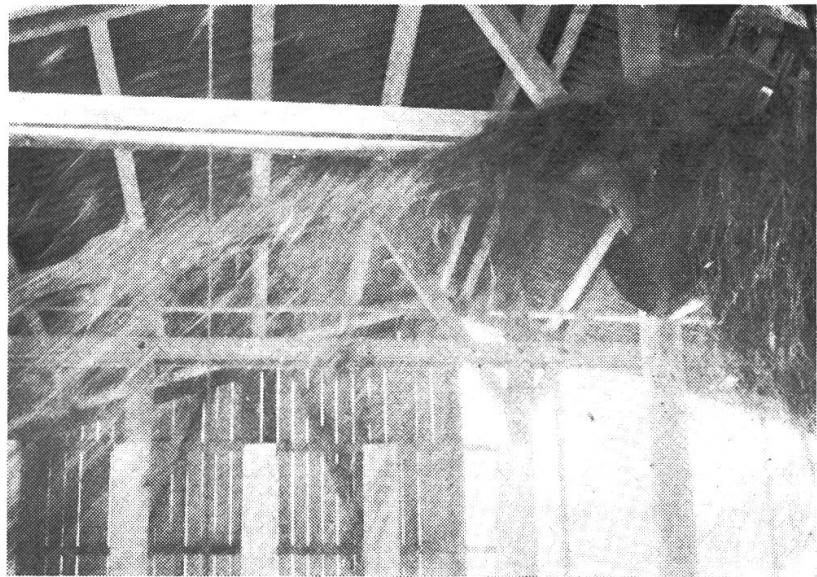
Abb. 10: Die Wurftrommel befindet sich in der rechten, oberen Bildecke. Die Futterhaufen werden sehr stark auseinander- gerissen, was besonders auf Belüftungsstöcken geschätzt wird.
