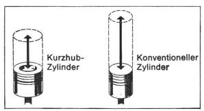
Dank dem quadratischen Bohrungs- und Hubverhältnis minimalste Abnützung.
