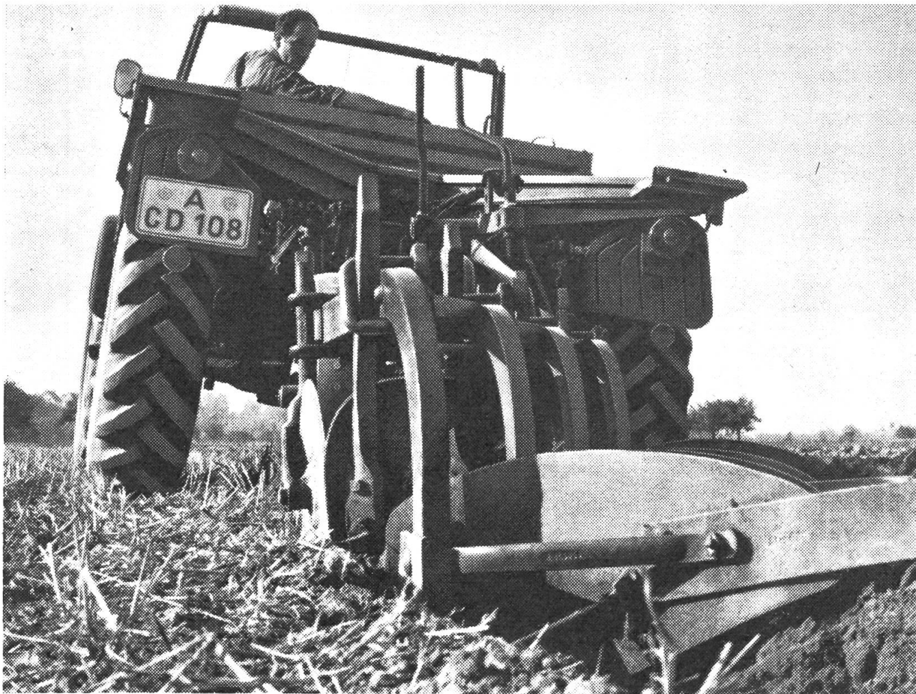
Unimog 406 mit einem vierscharigen Pflug. Dieses Foto zeigt Ihnen am besten, wie gut die Sicht nach hinten ist.
