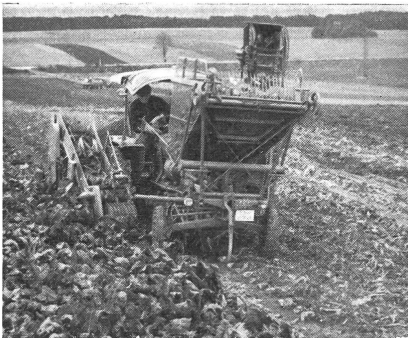
Selbstfahrender Zuckerrübenvollernter. Der als Grundmaschine dienende Geräteträger ist kaum noch erkennbar.
