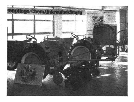
«Man soll den Zucker in die Rüben hacken.» Dieses Sprichwort wird auch in Zukunft an Bedeutung nicht verlieren. Mit dem Vielfachgerät, zusammen mit der Rübenhackgarnitur steht dem Pflanzer eine wirksame Maschine zur Verfügung. Die Zuckerrübe muss flach gehackt werden, somit sind Parallelogrammscharen und Pflanzenschutzscheiben unbedingt erforderlich. Auch darf die zusätzliche Feinsteuerung beim exakten Rübenhacken nicht fehlen.
