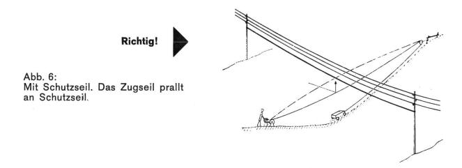
3. Ist ein Kreuzen der Starkstrom-Freileitungen nicht zu umgehen, so muss zwischen den beiden Leitungsstangen des gekreuzten Freileitungsstückes ein Schutzseil angebracht werden, damit ein hinaufschnellendes Zugseil die Freileitungsdrähte nicht berühren kann.
