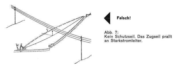
4. Mit der Anbringung des Schutzseiles darf nur das energieliefernde Werk beauftragt werden, das auch zur Klärung der zu treffenden Schutzmassnahmen beizuziehen ist.
