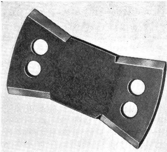
So sehen die vierseitig verwendbaren Mämmesser des Kreiselmäthers aus. Sind einmal die 4 Schneidkanten abgenutzt, wird das Messer weggeworfen. Der Anschaffungspreis ist so niedrig, dass sich ein Nachschleifen nicht rechtfertigen würde.
