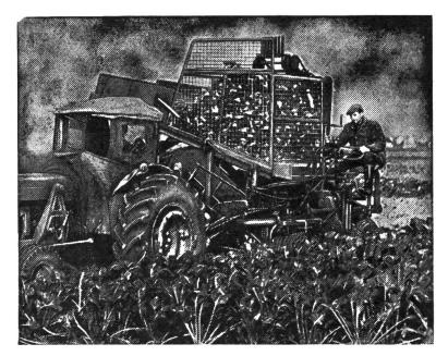
Ernten in einem Arbeitsgang. Vollhydraulisch mit Rübenbunker, erlaubt dadurch rascheste Ernte auch bei schwierigsten Bodenverhältnissen. Ein-Mann-Bedienung.
