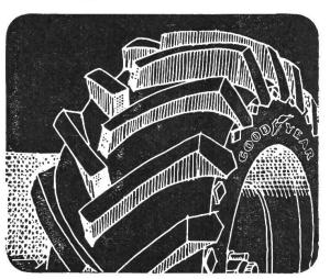
Keilförmig versetzte Riesenstollen sorgen für bessere Anzugskraft im Gelände.
