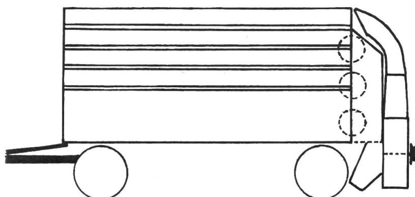
Häcksler hinten am Zweiachs-Sammelwagen angebaut. Die Ladung wird nach hinten in den Häcksler entleert. Der Häcksler wird beim Entladen als Fördergebläse benutzt.
