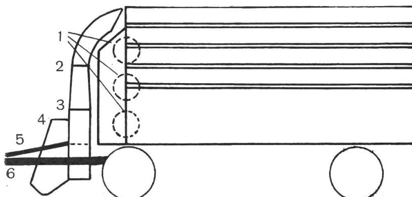
Häcksler vorne am Zweiachs-Sammelwagen angebaut. Die Entleerung der Wagen erfolgt mit Kratzboden von hinten nach vorne.
