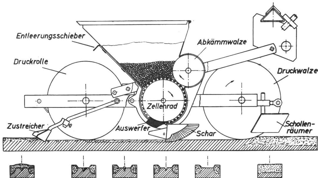
Einzelkornsägeräte werden als Einzelaggregate von der Landmaschinenindustrie angeboten und lassen sich an die verschiedensten Sämaschinen und Werkzeugschienen von Dreipunktgerätetrieben anbauen.
