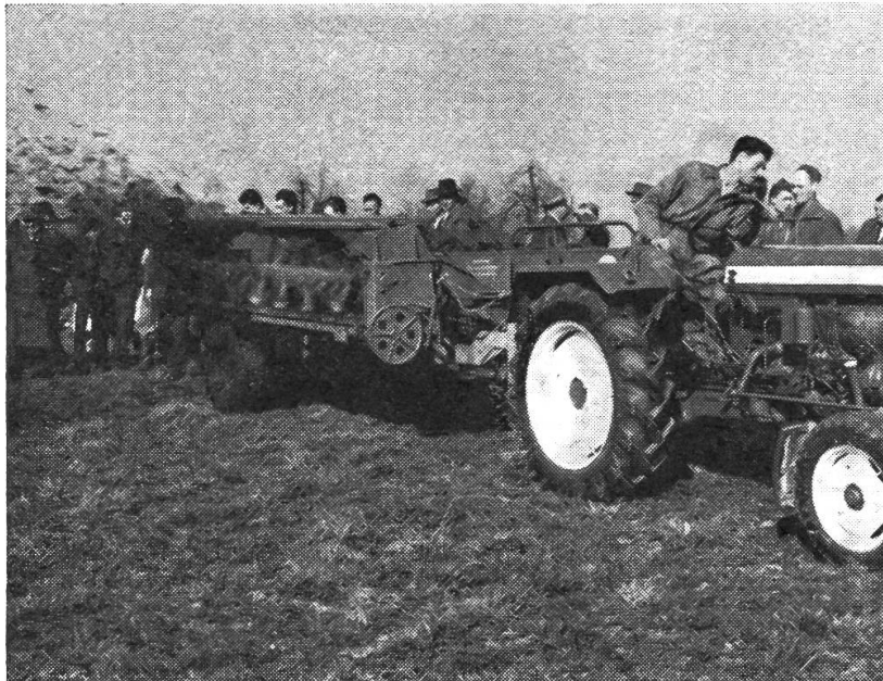
Abb. 8: Eingrossvolumiger Seiten- Aufbau-Miststreuer kann mit Traktoren ab ca. 20 PS-Motorleistung benützt werden. Bei dieser Ma- schine wird der Mist zu- erst aus dem hinteren Kastenfach ausgestreut. Die Umstellung erfolgt automatisch, sobald die- ser Kasten leer ist.
