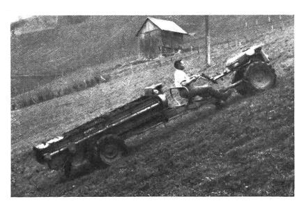
Schubwand. Im allgemeinen lassen sich bei einer Fahrgeschwindigkeit von 2 km/h auch bei seitlichem Streuen die für Wiesland üblichen Mistgaben gut ausbringen. Eine weitere Erhöhung der Streumenge ist bei dieser Arbeitsweise entweder durch die Verminderung der Fahrgeschwindigkeit oder durch nochmalige Ueberstreuung des Feldes möglich. Beim Streuen nach hinten wird eine doppelte Streumenge erreicht, da die Arbeitsbreite entsprechend geringer ist.
