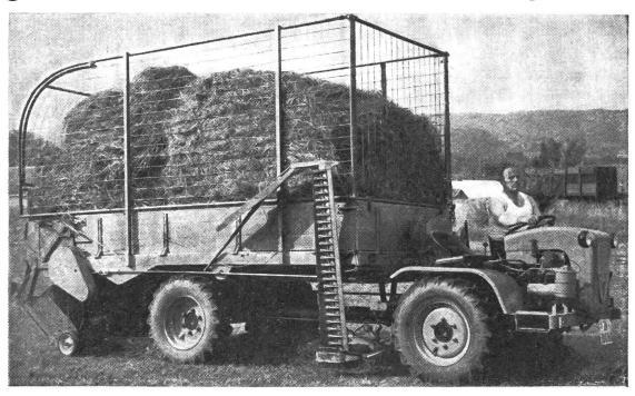
Der Mählader-PULLAX vereinigt in einer Einheit Ladewagen, Mähmaschine, Miststreuer sowie Entladewagen z.B. für Runkeln, Kartoffeln etc. Er kann mit wenigen Handgriffen an beliebiger Stelle abgesattelt werden. Dann kann der PULLAX verwendet werden als: Ackertraktor mit Normhydraulik, idealer Forsttraktor, Kipper, Schneeräum-Maschine etc. etc.
