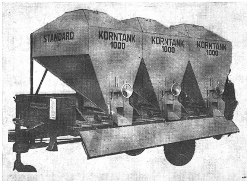
Abb. 22: Asymmetrische Aufsatz- behälter (Bild: Fa. Standard-Ver- trieb Schulze, Bevensen)
