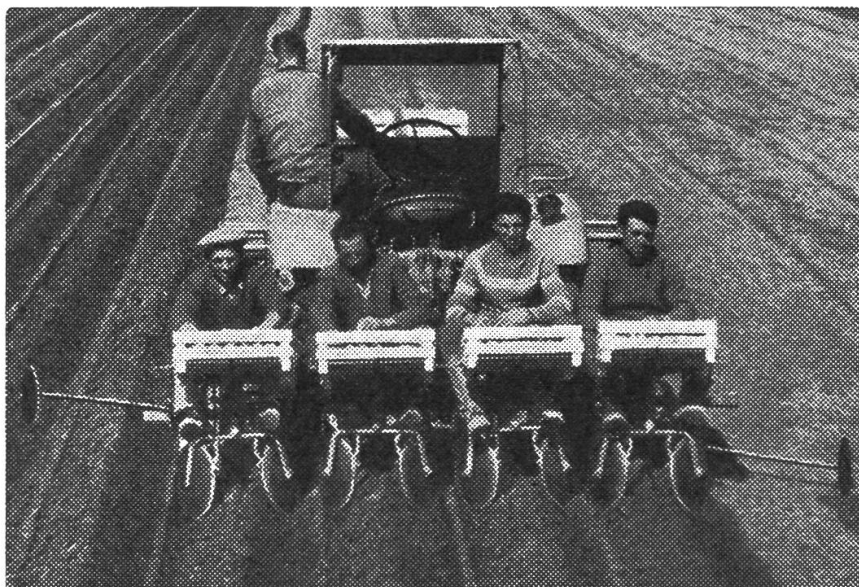
Kartoffelsetzen 4-reihig mit unseren Patent-Setzautomaten.
