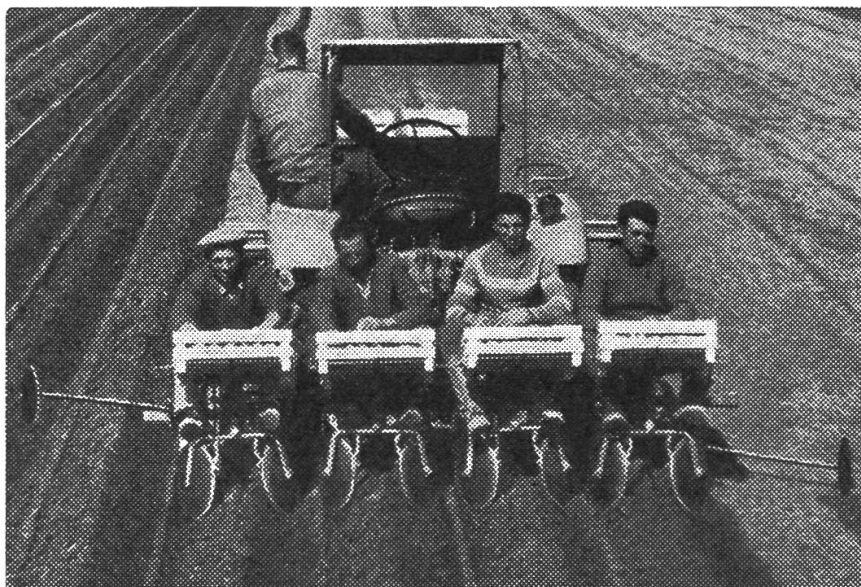
Kartoffelsetzen 4-reihig mit unseren Patent-Setzautomaten.
