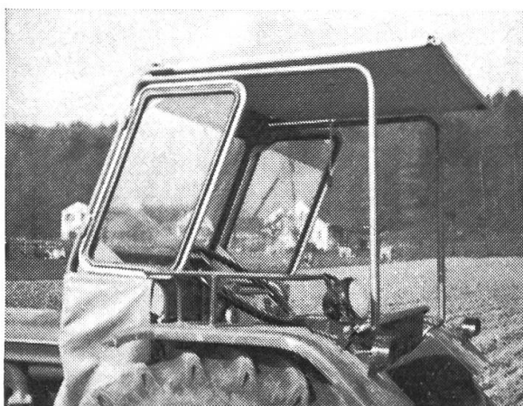
Abb. 1: In der Schweiz sind vorläufig nur sogenannte Leichtverdecke mit Seitenflügeln bis zu 25 cm zugelassen (siehe Abbildung). Sturzverdecke und fest angebrachte Sturzbügel sind noch nicht gestattet.
