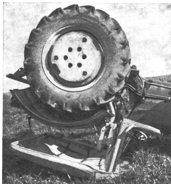
Abb. 4: Traktorsturzerdeck nach einem Ueber-schlagsversuch. Das Verdeck hat überhaupt keinen Schaden genommen. Es ist also anzunehmen, dass der Fahrer mit dem Leben davon gekommen wäre, wenn er sich im Verdeckinnern hätte festhalten können.
