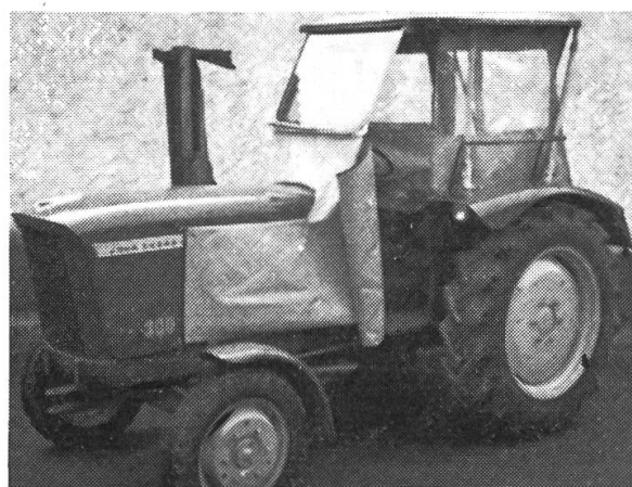
Abb. 2: Leicht demontabler Wetterschutz für das Arbeiten bei ungünstiger Witterung. Der Aufbau behindert weder die Sicht noch die Bewegungsfreiheit. Im Sommer kann die Windschutzscheibe hochgeklappt, die Seitenverkleidung abgenommen und das Dach eingerollt werden. Das ist ein wahrer Wetterschutz!
