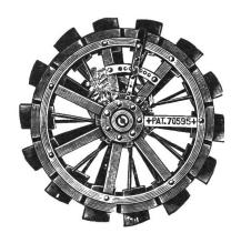
Ansicht eines der ersten Traktorräder, das den Einsatz vom Transport zum Arbeiten im Acker beschleunigen und erleichtern sollte. Es handelt sich um ein Modell Meyer, das mit Gummiklötzen und herausstellbaren Schaufelstollen ausgerüstet war. Der Präsident einer welschen Sektion hat das Wort
