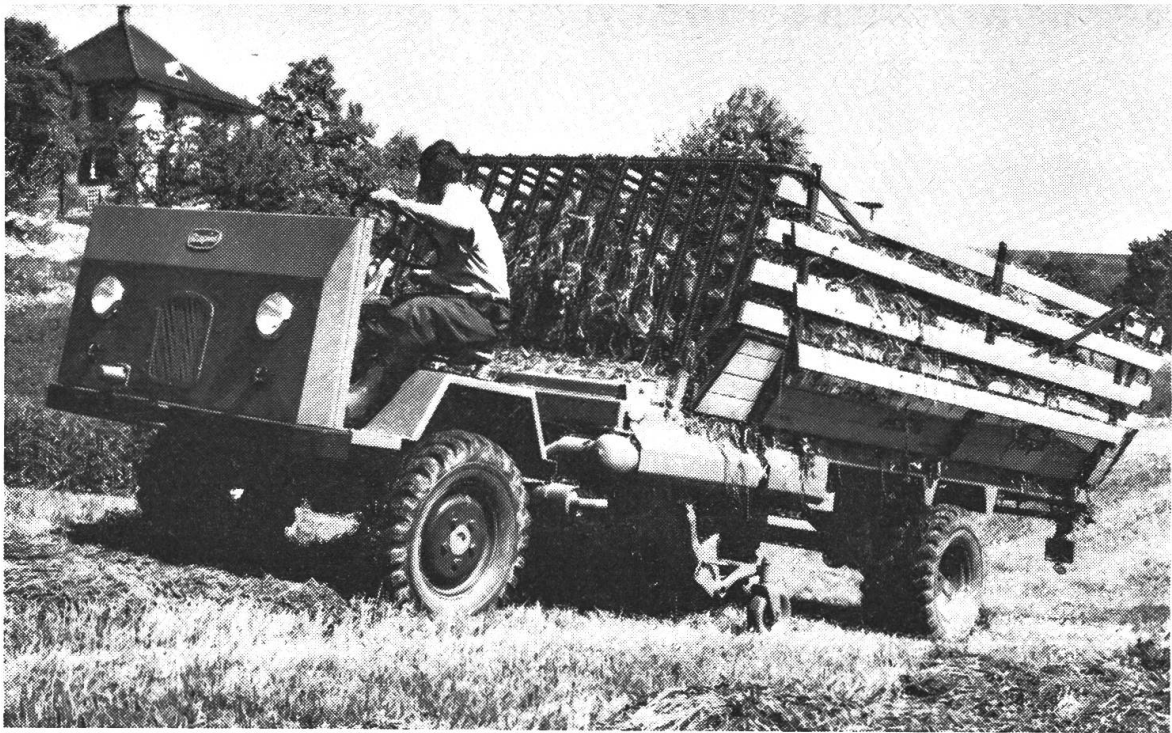
Abb. 2: Die optimale Gewichtsverteilung, der Allradantrieb und die Doppelbereifung bewirken, dass der RAPID CARGOTRAC keine schädlichen Bodendrücke ausübt.
