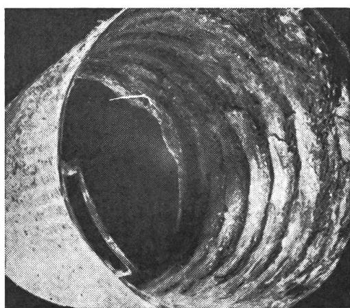
In diesem Zustand ist der Sortierzylinder völlig funktionslos.
