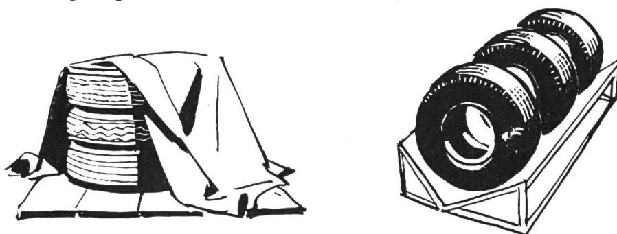
Werden montierte oder abmontierte Reifen im Freien gelagert, dann sind sie, mit einem wasserdichten Material umwickelt, auf einem gesäuberten und schattigen Ort aufzubewahren.
