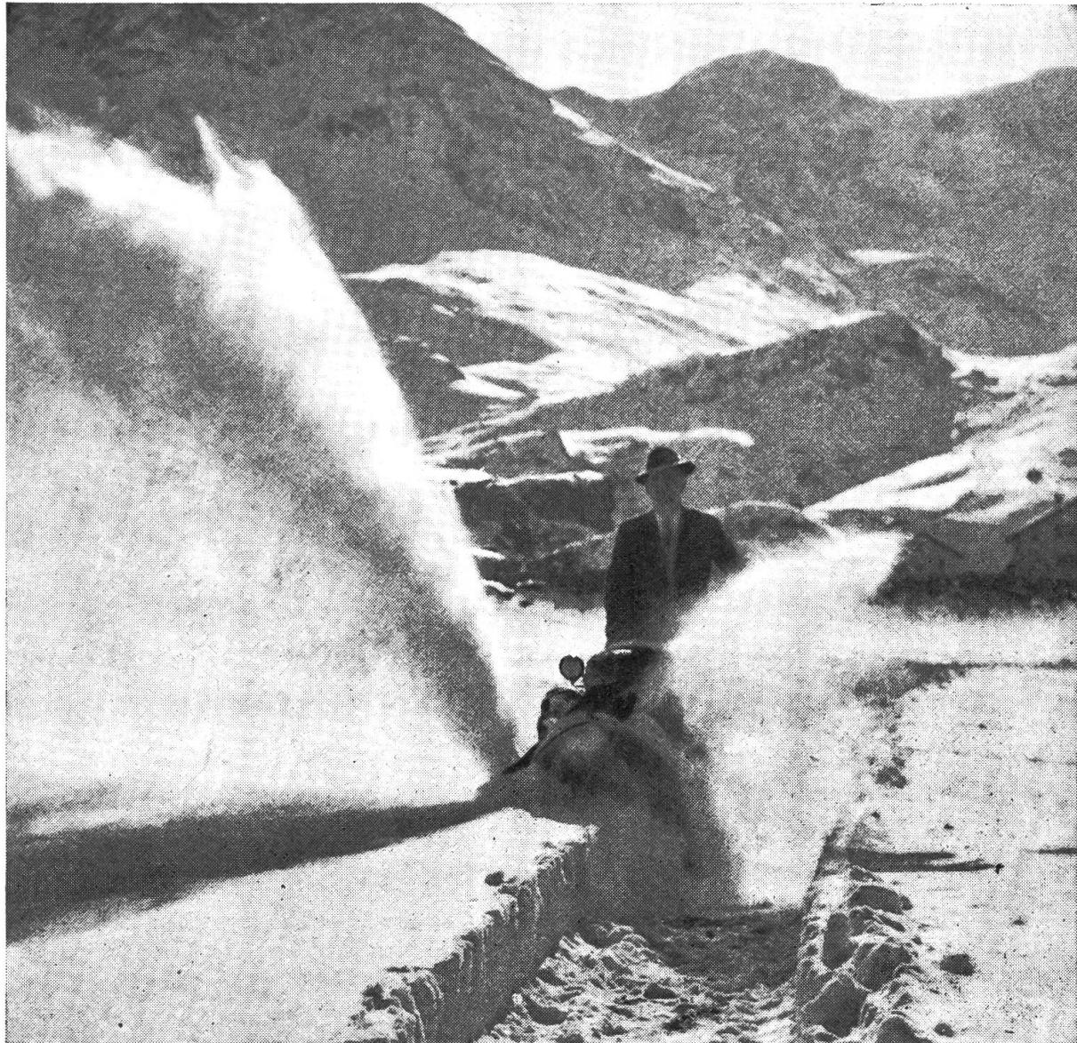
**Schneeschleuder** Bestens geeignet zur Schneeräumung auf Wegen, Trottoirs, Zufahrten und Parkplätzen, Arbeitsbreite 70 cm, Wurfweite 10 bis 15 m, Auswurf verstellbar nach links und rechts
