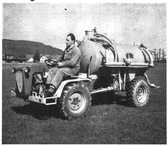
Mit dem Saug- und Druckfass wird das Düngen sehr arbeitssparend ausgeführt. Diese Anordnung ist eine weitere Spitzenleistung im Merk-Pullax-Geräte-System.
