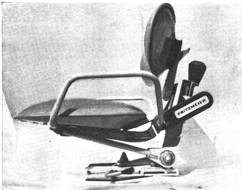
Abb. 3: Beispiel eines Traktorsitzes mit Kunststoffpolsterung und Rücken- und Seitenlehne.
