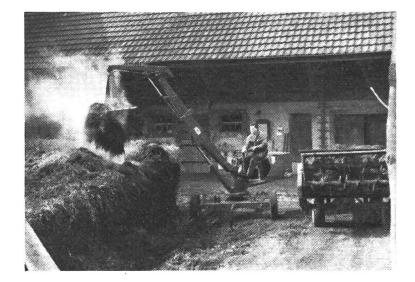
Abb. 6: Kleiner fahrbarer Hydrauliklader mit Explosionsmotor.
