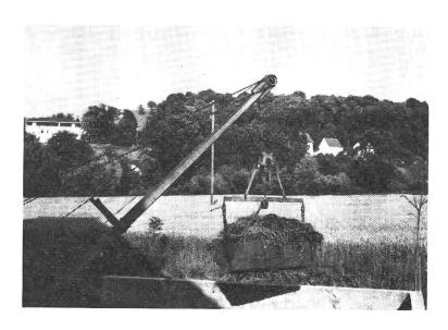
Seilkrane sind mindestens mit 2 Seilwinden ausgerüstet. Diese dienen zum Schliessen und Heben der Greiferzange und zum Verstellen des Auslegerarmes. Die Zange lässt sich zum Entleeren in einer bestimmten Höhe festhalten oder muss auf dem Wagen abgesetzt werden. Praktischer und anpassungsfähiger sind Seilkrane, bei denen ein spezielles Halteseil über
