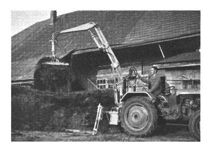
Abb. 11: Hydrauliklader auf Traktor abgestützt. Alle Bewegungen erfolgen hydraulisch.
