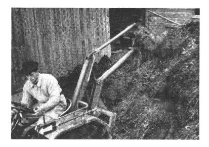
Abb. 10: Hecklader an Dreipunkt. Das vis-à-vis des Frontladers, jedoch mit kleinerer Leistung und unbequemer Haltung der Bedienungsperson.
