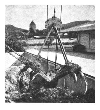
Abb. 1: Selbstgreifende **Zange**.
