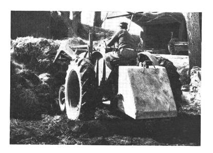
b) Traktor mit Hecklader an Dreipunktaufhängung. Es sind heute verschiedene einfache Heckladergeräte auf dem Markt erhältlich. Sie werden an der Dreipunkt-Aufhängung angebaut und über die Hydraulik betätigt. In der Regel handelt es sich um leichte, weniger leistungsfähige Geräte für nicht zu hohe Ansprüche. Aeusserst nachteilig ist beim Arbeiten mit diesen Heckgeräten die unbequeme Haltung der Bedienungsperson.
