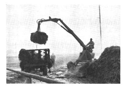
Abb. 7: Grosser fahrbarer Hydrauliklader mit Elektromotor, wie er für grössere Maschinengemeinschaften geeignet ist.
