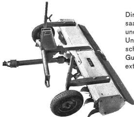
Direktes Hacken der Stoppeln für Zwischensaat. Einhacken von Mist, Gründüngung und Ernterückständen. Extra-Einstellung zur Unkrautbekämpfung. - Durcharbeitung auch schwerster Böden in einer Durchfahrt. Gummiblock abgefederte Spatenwelle für extreme Verhältnisse.
