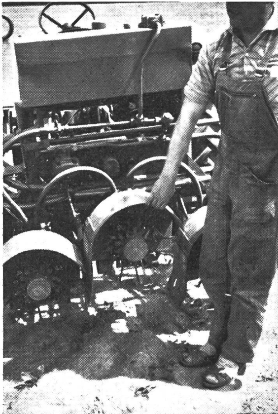
Abb. 2: Die Fräsaggregate sind einzeln im Parallelogramm aufgehängt. Das Gerät lässt sich daher auch auf unebenen Äckern einsetzen.
