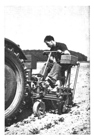
Abb. 3: Neben dem Feinsteurmann der Elektronikkasten. Ein Zahnband überträgt von einem Bodenrad den Vorschub zu ihm hin... Natürlich kann man auf den Feinsteuermann verzichten, wenn man mit der Maschine einmal eingearbeitet ist.
