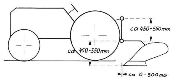
Abb. 4: Für Traktoren mit Regelhydraulik eignen sich am besten kurzgebaute Pflüge mit hochangebrachter Anbauschiene. Die Angaben über die Pflugabmessungen sind als grobe Richtlinien für Dreipunktaufhängung und Norm I zu betrachten.
