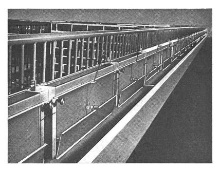
Die automatische Fütterung ist bei der Schweine- und Hühnerhaltung am weitesten vorangeschritten. Die Transportorgane bestanden bei allen Anlagen aus Förderketten. Als Neuheit wurde die sogenannte Mehlschlange gezeigt. Sie besteht aus einem PVC-Rohr, in welchem eine Stahlspirale rotiert und wird für den Transport von Futtermehlen zum Füllen von Futterautomaten benützt.
