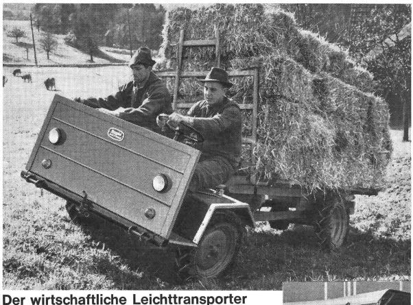
mit der grossen Ladefläche. Allradantrieb, Differentialsperre und kleiner
