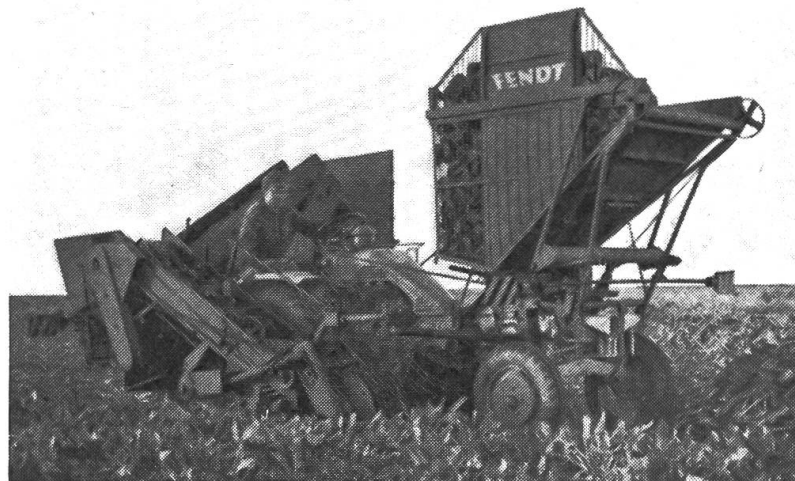
Abb. 10: Auf Geräteträger aufge- bauter Zuckerrübenvoll- ernter
