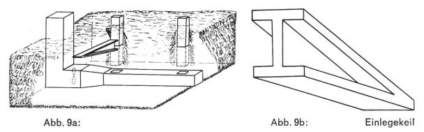
Beispiel für das Einlegen von Einlegekeilen. Wenn der Heulüfter in den Hauptkanal zurückversetzt wird, so ist es oft schwierig, die äussersten Ecken genügend zu belüften. Durch die Einlegekeile (Abb. 9b) kann die Luft den entferntesten Partien zugeführt werden.
