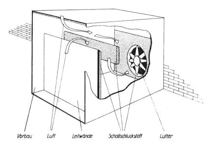
Abb. 10: Bei vorhandenen Anlagen muss der Schalldämpfer vielfach vor das Gebäude vorgesetzt werden.
