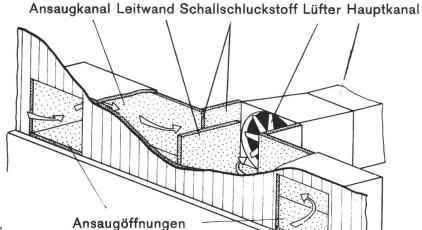
Abb. 8: Beispiel für eine Gebläse-Schallabschirmung nach beiden Seiten.
