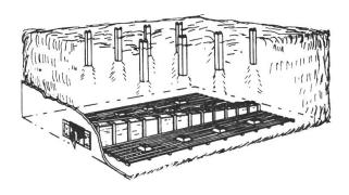
Abb. 6: Schema für eine Belüftungsanlage mit verjüngtem Hauptkanal, mit Seitenrosten und mit Stöpseln.
