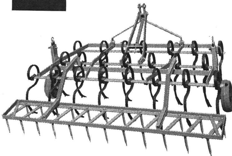
In 4 Grössen von 1,8 m bis 2,5 m Arbeitsbreite lieferbar. Die Zinken aus Spezialfederstahl bewähren sich ausserordentlich gut und sind praktisch unverwüstlich. Schare aus gehärtetem Sonderstahl mit langer Lebensdauer.
