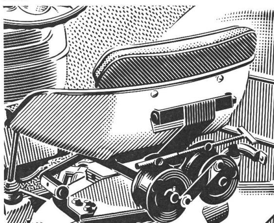
Einzelheiten der Bostrom-Sitzaufhängung, mit denen nunmehr sämtliche Ford-Traktoren ausgerüstet werden.
