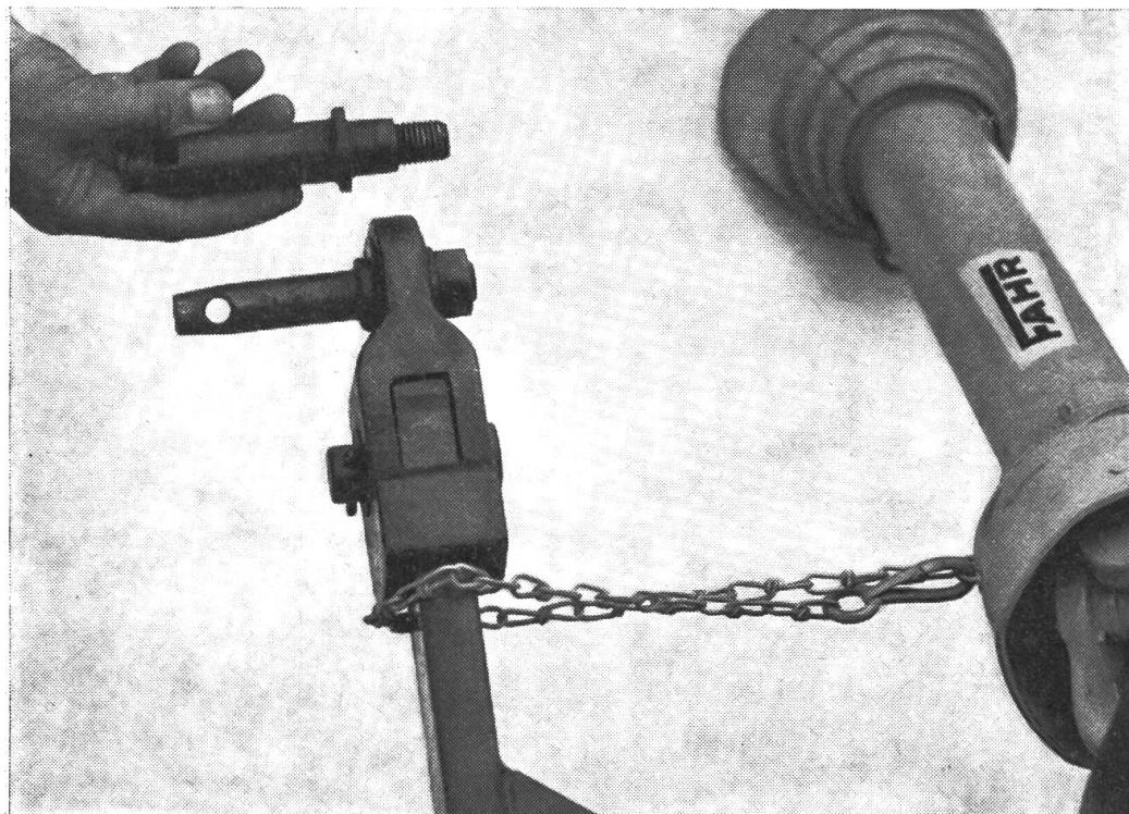
Achten Sie beim Kauf von Dreipunkt-Anbaugeräten darauf, dass die für Ihren Traktor passende Bolzengröße bestellt wird! Bei den meisten Geräten lassen sich die Bolzen für die beiden Größen wie auf dem Bild wechseln (Werkfoto FAHR).
