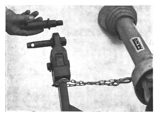
Achten Sie beim Kauf von Dreipunkt-Anbaugeräten darauf, dass die für Ihren Traktor passende Bolzengrösse bestellt wird! Bei den meisten Geräten lassen sich die Bolzen für die beiden Grössen wie auf dem Bild wechseln (Werkfoto FAHR).
